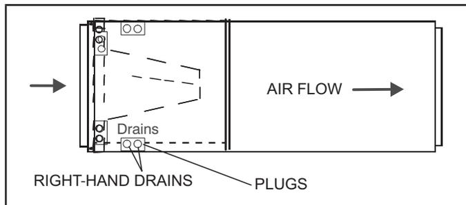
**FIGURE 16. Right-Hand Discharge Configuration**
